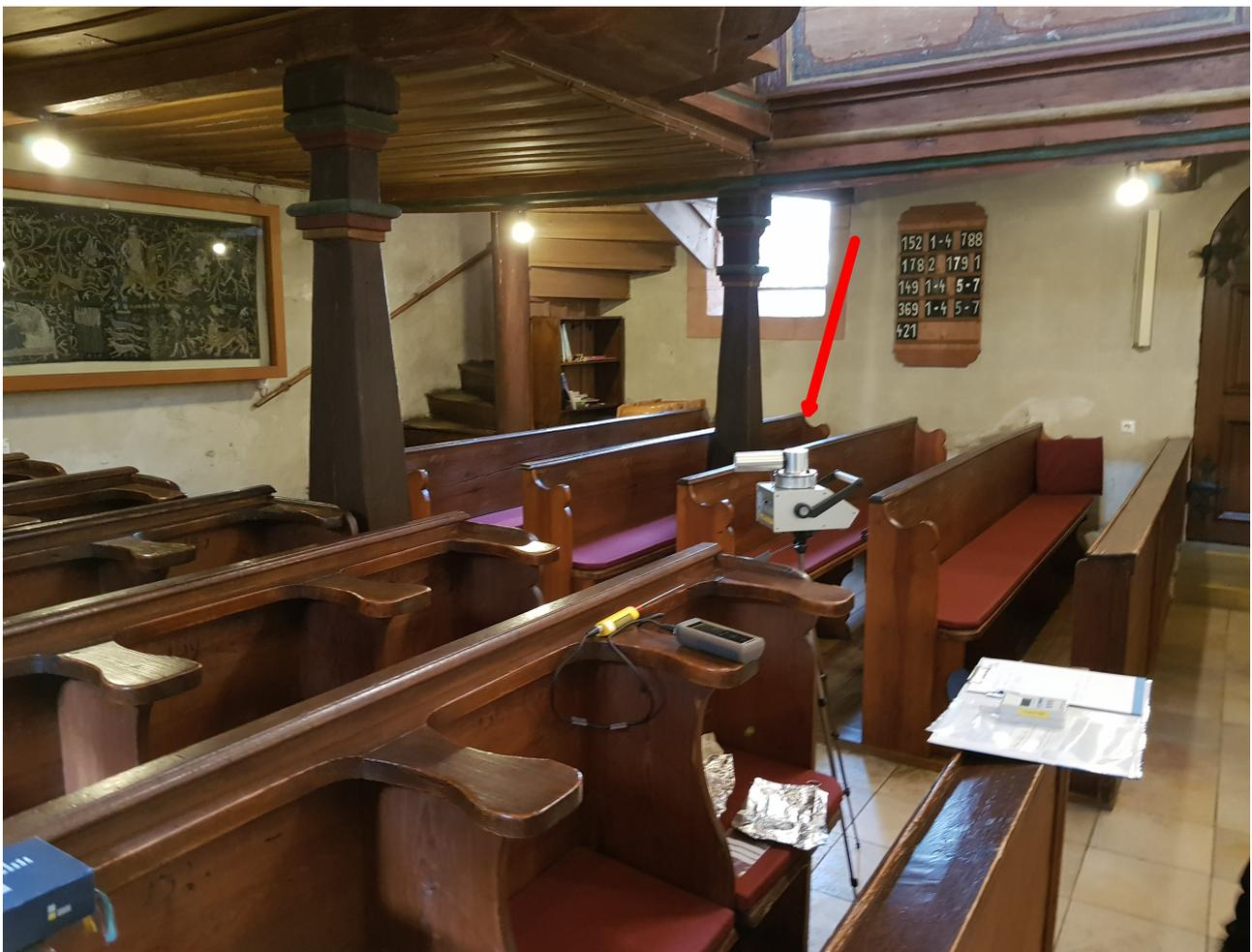
Abbildung 1: Probenahme mit der Pumpe unter der Empore
