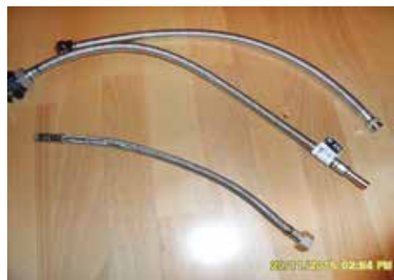
Stahlflexschläuche sind außen aus einem Stahlfasergeflecht und innen aus Kunststoff oder Gummi
