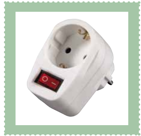
Abbildung 2: Billigprodukt, bei dem der Schalter nur einpolig schaltet und deshalb nur zufällig zu einer Feldreduktion beiträgt, je nachdem, wie der Stecker drinsteckt!
